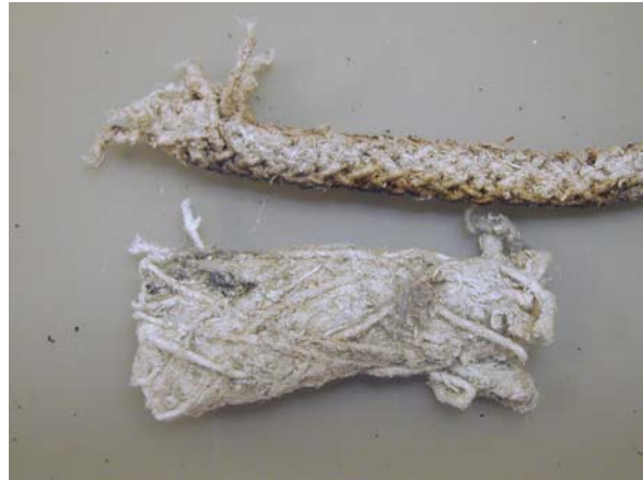
Cordoni d'amianto impiegati quale isolante in punti facilmente infiammabili, foto: JMF/SLE, IST
