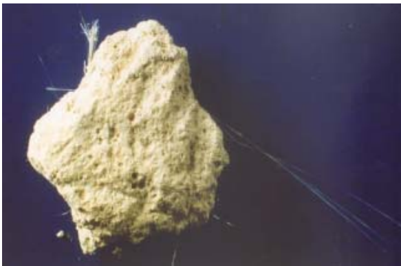
Malta di un'isolazione di tubazioni contenente amianto con ciuffi di fibre d'amianto, foto: SA
